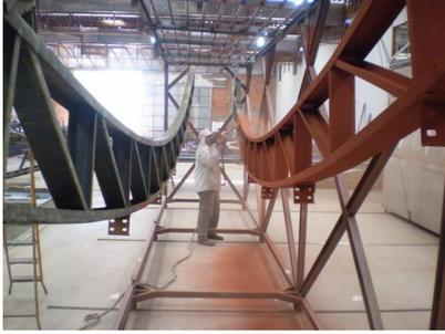
No processo de aprimoramento, modernização, preocupação com o MEIO AMBIENTE e aumento de qualidade nos produtos fabricados pela AJJ, no ano de 2009, implantamos o processo de Pintura Eletrostática.
